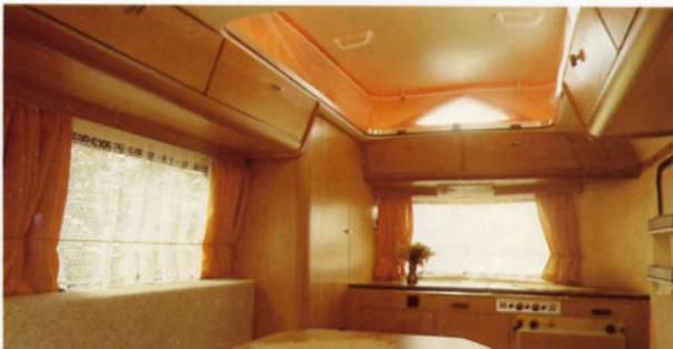
**LA VENTILATION** – Ce toit télescopique qui contribue tant à la tenue de route des ERIBA est maintenant monté sur des vérins à gaz donc encore plus facile à manœuvrer. (Avez-vous remarqué qu'il assure la meilleure ventilation possible en séjour.) Sur ces côtés, absolument étanches, sont disposés des orifices réglables à volonté par fermetures à glissières formant lanterneaux; ainsi vous obtenez toujours la ventilation désirée en plein soleil ou aux sports d'hiver.
